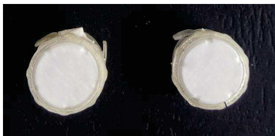
Figure 5-11 : Photo de membranes HA-PVA-HP \beta CD montées sur des CellCrown
