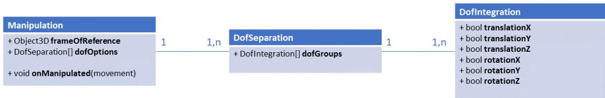
FIGURE 2.12 – Brique d'interaction manipulation et contrôle de l'intégration et de la séparation de degrés de liberté.
