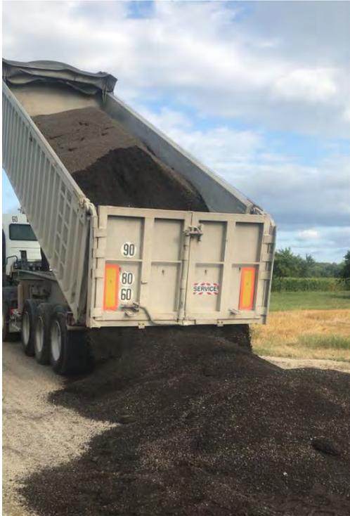
*Figure V.19 Déversement des AE humidifiés en centrale*
