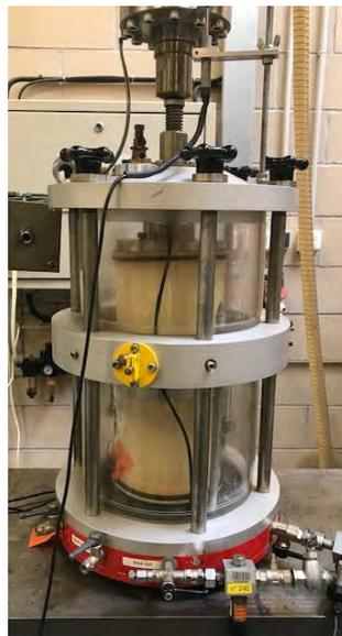
*Figure II.22 Cellule triaxiale de l'IFSTTAR de Nantes*
