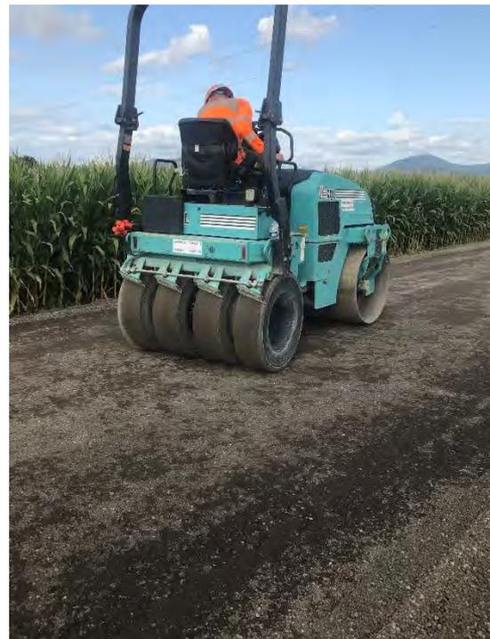
*Figure V.25 Compacteur combiné vibrant à cylindre*
