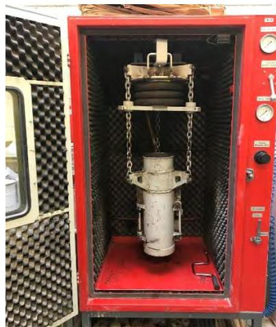
*Figure II.26 Machine de vibrocompression à l'IFSTTAR de Nantes*
