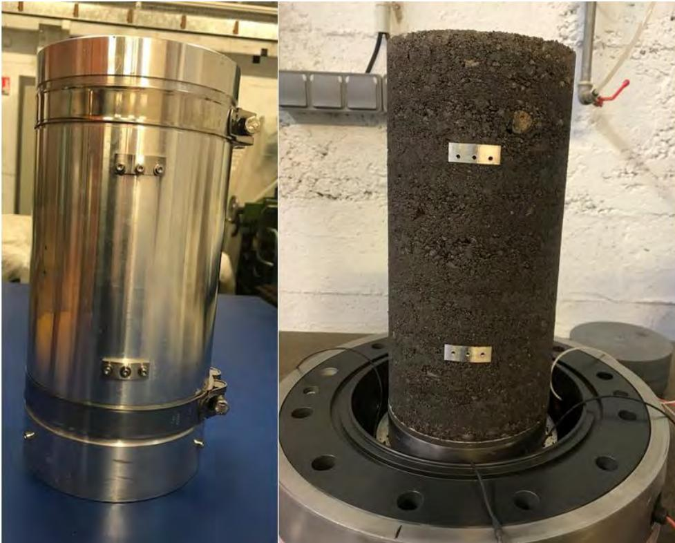
*Figure II.28 Supports de fixation des capteurs axiaux*
