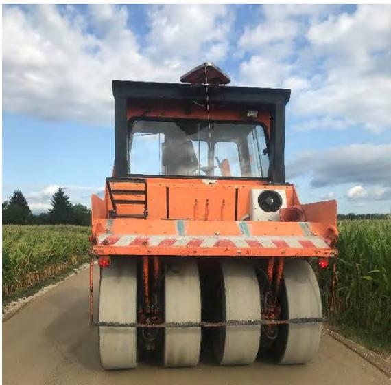
*Figure V.24 Compacteur à pneus*
