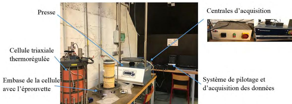
Figure II.14 Vue globale du dispositif triaxial de l'INSA de Strasbourg
