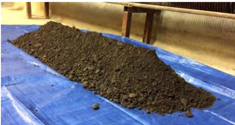
*Figure II.12 Stockage intermédiaire des agrégats d'enrobés sous forme pyramidale*
