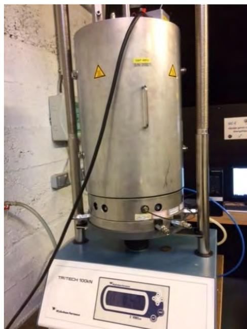
*Figure II.17 Cloche isolante*
