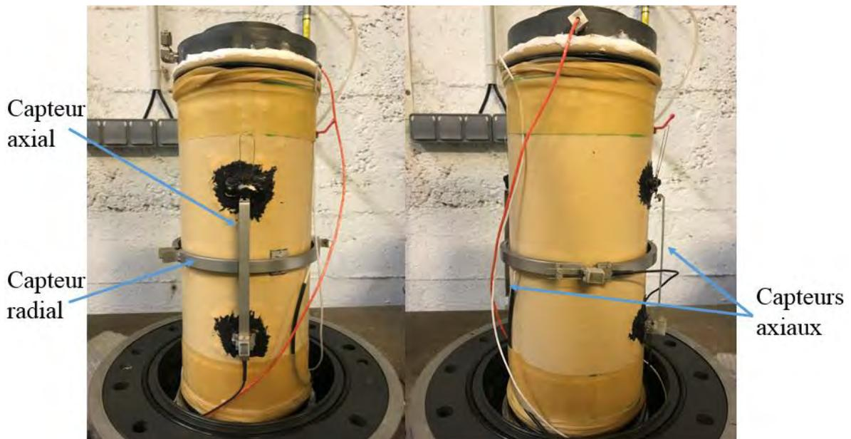
Figure II.30 Eprouvette instrumentée
