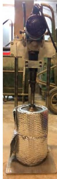
*Figure II.25 Compactage au marteau vibrant à température imposée*
