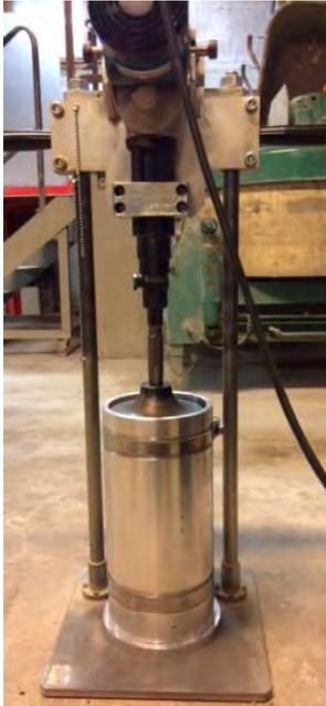
*Figure II.24 Compactage au marteau vibrant à l'INSA de Strasbourg*
