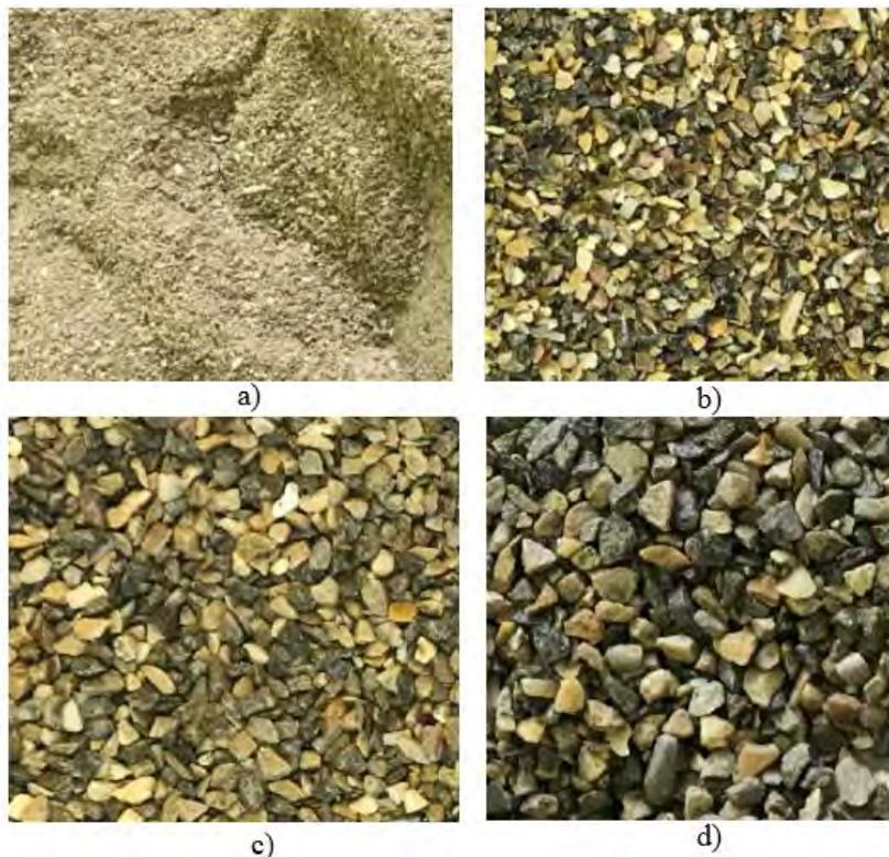
Figure II.9 Fractions granulométriques a) 0/4 b) 4/6 c) 6/10 d) 10/14
