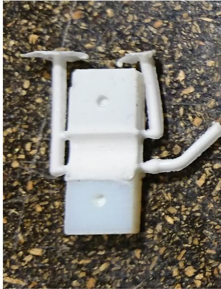
FIGURE 4.20 – Charnière obtenue en sortie de moule, avant retrait des canaux de moulage et de dégazage.
