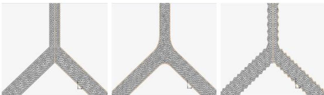
Figure 11. Modèles d'éléments finis : géométrie représentative de cellules 2D avec des bords plats (à gauche), des bords arrondis de jonction/plateau (au milieu) et des bords ondulés (à droite). Il est notable que la porosité du modèle à jonctions arrondies est similaire (différence de seulement 0,4 %) à celle du modèle à bords plats, alors que celle du modèle à bords ondulés est 2,4 % plus importante.
