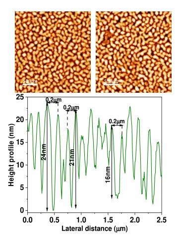
**Figure 3:** panneau supérieur: image AFM de la surface d'un échantillon protégé par 10nm d'Au. Panneau inferieur : profil de la surface ; la rugosité est très élevée, d'une profondeur de 20 nm.
