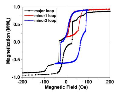
**Figure 8:** Courbe d'aimantation et cycles mineurs d'un échantillon Fe(30nm)/ZnTPP(20ML)/Co(5nm)/ZnTPP(20ML)/Fe(30nm). Les cycles mineurs sont tous les deux décalés dans le sens positif ce qui traduit la présence d'un couplage antiferromagnétique.
