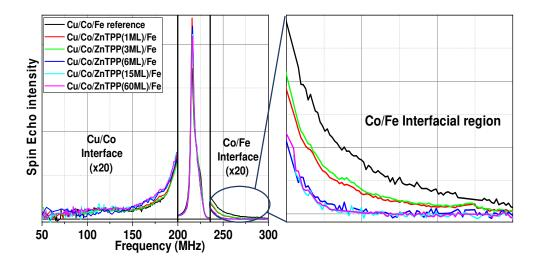
**Figure 4:** Evolution des spectres FNR avec augmentation de l'épaisseur de la couche de ZnTPP. La partie haute fréquence (>240 MHz) diminue avec l'augmentation de l'épaisseur et disparait à partir de 15 ML.
