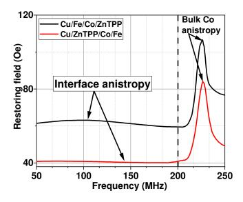
**Figure 6:** Anisotropie magnétique de la couche de Co des hétérostructures en fonction de la fréquence. L'anisotropie des interfaces < 200 MHz) est toujours plus faible que celle du centre des couches (> 200 MHz).
