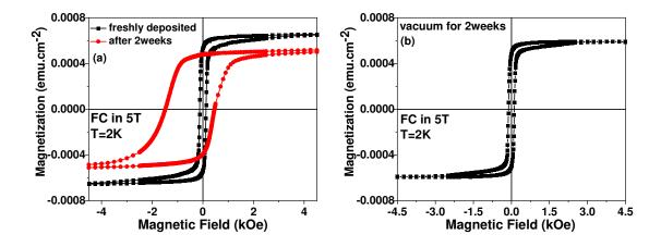
**Figure 2**: Courbes d'aimantation a) échantillon Co(6nm)/ZnTPP(10nm)/Au(50nm) fraichement préparé (en noir) et remesuré deux semaines plus tard (en rouge) (b) échantillon Co(6nm)/ZnTPP(10nm)/Au(50nm) vieilli pendant deux semaines en UHV mesuré directement après sa sortie du vide.
