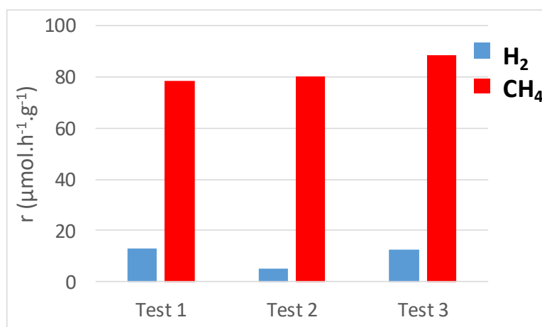
Figure 2.14 : Vitesses massiques moyennes de production de H 2 et CH 4 obtenues pour le solide Pd(1%)/TiO 2 .
