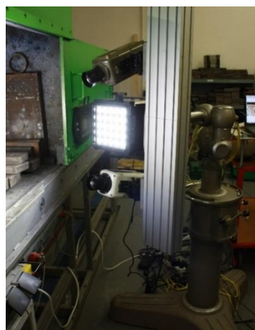
Figure 4-11 : Système d'acquisition de stéréo corrélation d'images.
