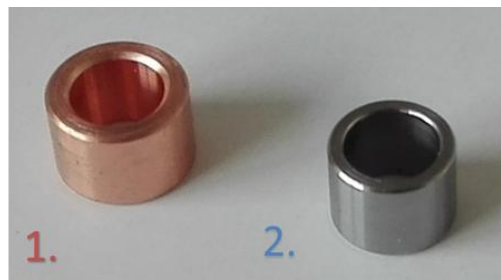
Figure 2-12 : Confinement utilisés lors des essais de compression.
