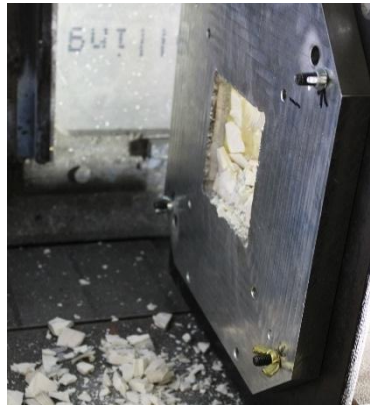
Figure 4-14 : Face avant d'une structure double dureté après impact et sans gel balistique
