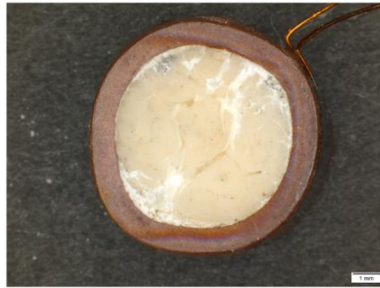
Figure 2-20 : Échantillon endommagé après chargement à rupture
