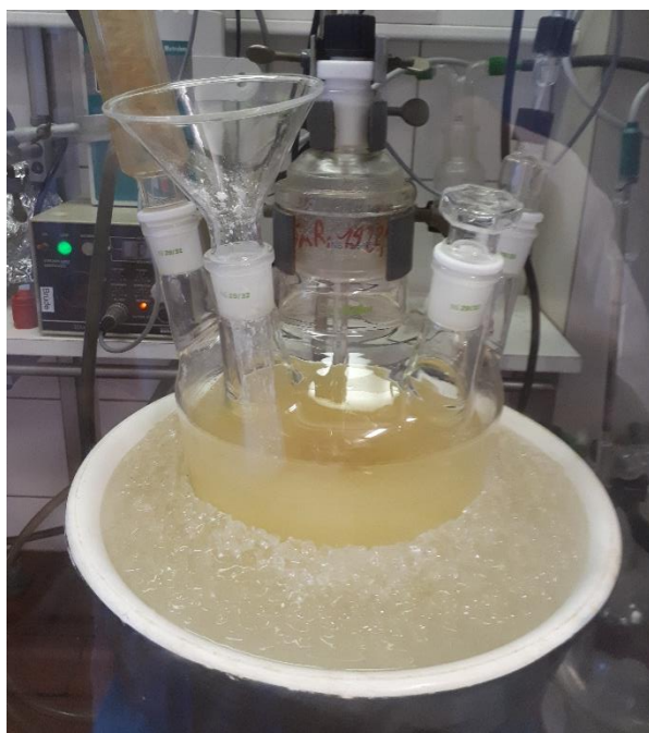
Solution d'acide citrique, de \text{TiCl}_3\text{OEt} et de zinc avant addition de l'ammoniaque
