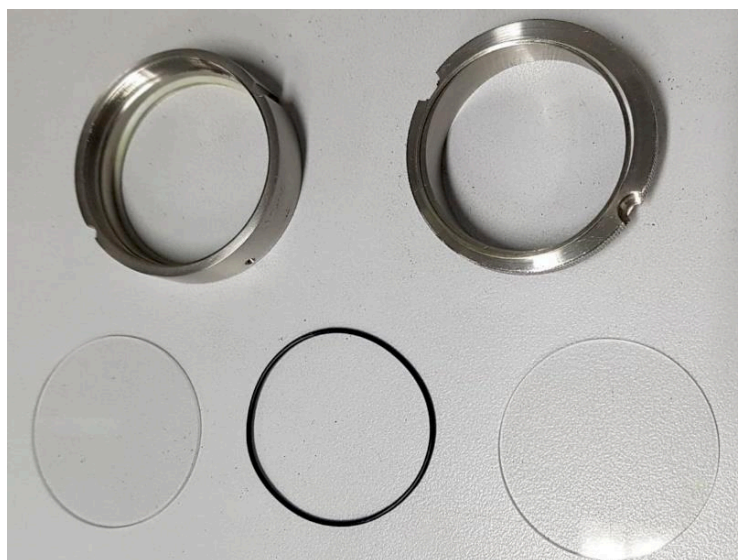
Figure 21 : a) cellule tournante montée sur son support, les flèches rouges indiquent le sens de rotation de la cellule et les bleues la trajectoire des faisceaux pompe et sonde b) cellule tournante démontée, composée de deux lames de verre, d'un joint EPDM, et d'un support métallique pour serrer les lames entre elles et éviter des fuites de l'échantillon
