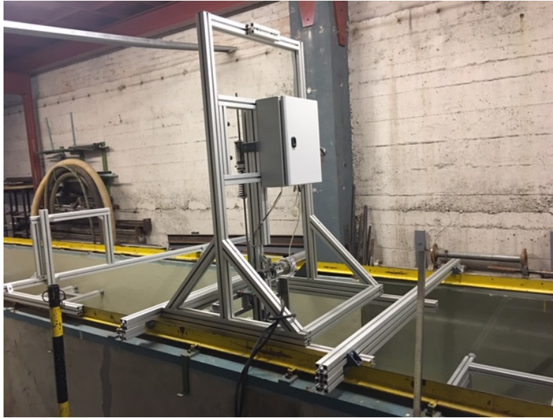
FIGURE 4.13 – Emplacement du boîtier électrique contenant l'ensemble de l'électronique embarquée.
