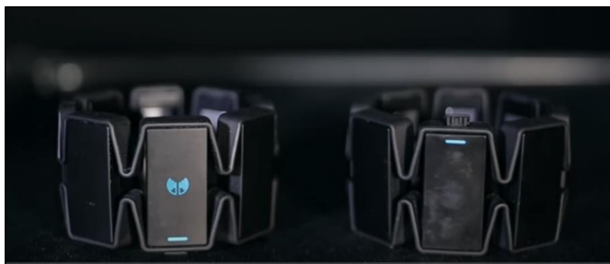
Figure 36 : Les bracelets Myogram. Chaque bracelet a quatre électrodes pour capter les signaux impulsions des neurones 186 .
