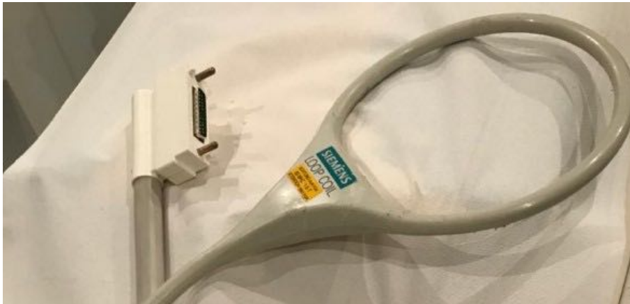
FIGURE 3.17: Exemple d'antenne IRM dédiée aux procédures de radiologie interventionnelle (Siemens Healthineers, Allemagne).
