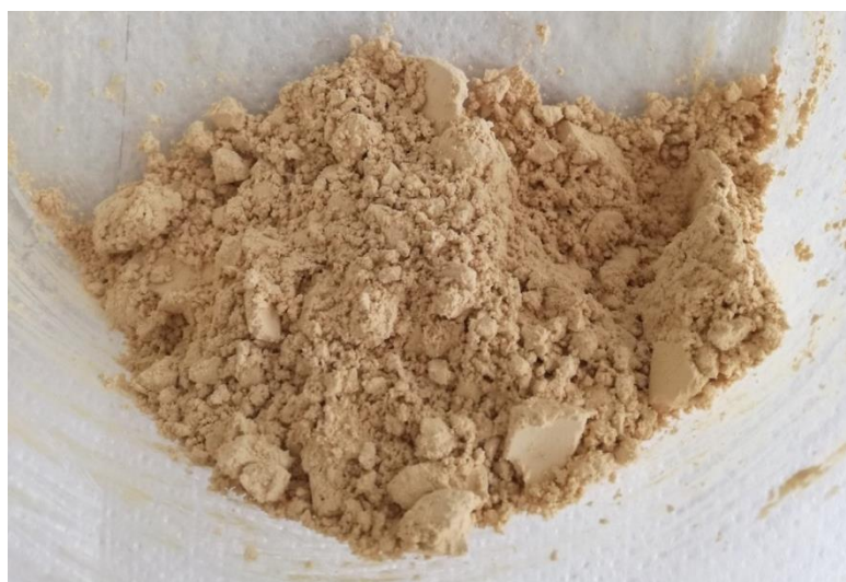
Figure 33 : poudre de LTM produite en sortie d'atomisation.
