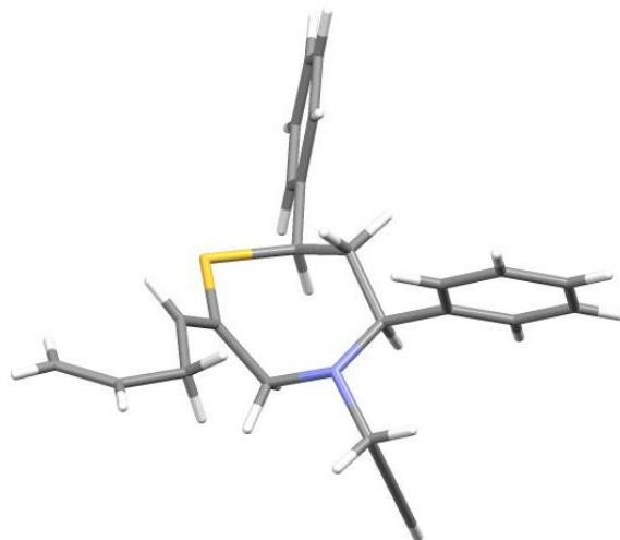
Figure 19 : Structure cristallographique de 8a analysée par diffraction des rayons X
