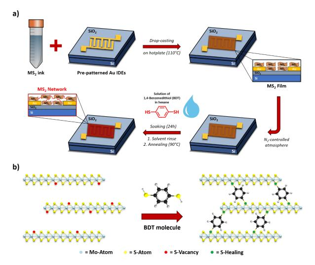
**Figure I : a)** Illustration du dépôt d'encre et de la fonctionnalisation in situ pour produire des réseaux de MS<sub>2</sub> par traitement au BDT. **b)** Esquisse du mécanisme de guérison des V<sub>S</sub> dans les couches de MoS<sub>2</sub> au moyen de molécules dithiolées et de la mise en réseau inter-flocons associée
