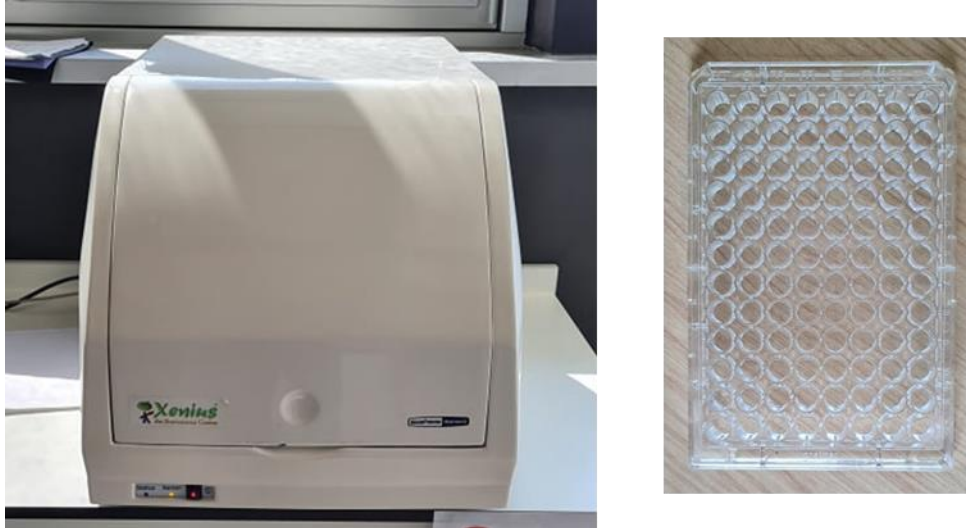
Figure 2.39. (gauche) Photographie d'un lecteur de microplaques FLX Xenius SAFAS MONACO ; (droite) plaque Corning 96 puits spéciale UV.
