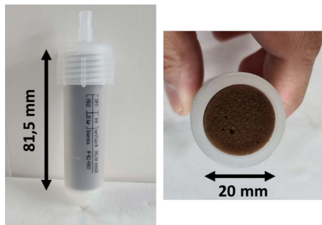
Figure 5.33. Photographie d'une colonne de charge sèche garnie de mousses me@PDA, facilement utilisable dans un dispositif en flux continu.
