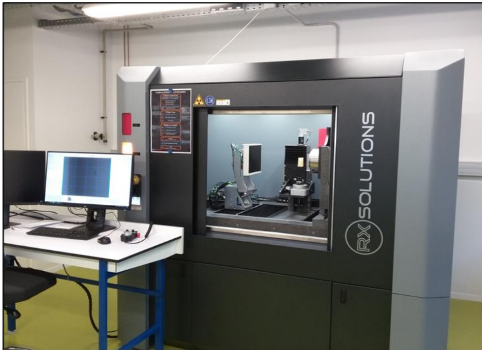
Figure 2.35. Vue générale : (gauche) ordinateur utilisé pour la gestion du tomographe ; (droite) cabine (radio-protection contre les rayonnements ionisants)
