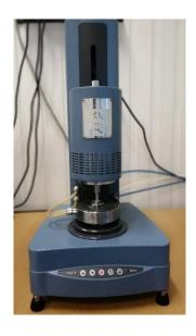
Fig. 2.1 AR2000 rheometer.
