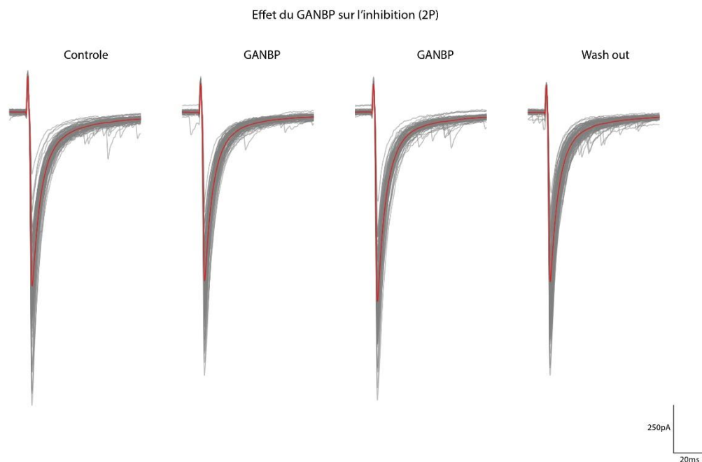
Figure 34 : Effet du GANBP seul sur la transmission inhibitrice entre les interneurons de la couche moléculaire et les cellules de Purkinje. Courants post-synaptiques inhibiteurs enregistrés dans une cellule de Purkinje en patch clamp (voltage imposé à -60\text{mV} ) induit par stimulation électrique d'un interneurone de la couche moléculaire en présence ou non de GANBP dans la solution de perfusion. Exemple de traces obtenues pour une cellule. Les traces brutes sont représentées en gris et la trace moyenne en rouge.
