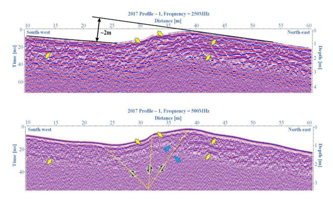
**Figure 4**. Résultat de l'interprétation de l'mage radar du profil-1 (acquis en juin 2017) de la zone 2 (structure chevauchée) de la faille de Mogod. La première figure est obtenue avec l'antenne de 250 MHz. La deuxième figure est obtenue avec l'antenne de 500 MHz. Les flèches jaunes montrent les réflexions des couches, les flèches bleues correspondent au même calque, les lignes orange correspondent aux couches réfléchissantes, les flèches noires indiquent la direction du mouvement.
