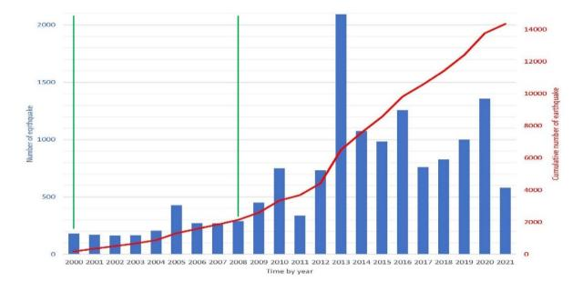
**Figure 1**. Nombre de séismes cumulé entre 2000 et 2021 (superficie de 140x140 km). La ligne verte est l'heure de début de l'installation de la nouvelle station, en 2000 l'installation du « tableau CTBT Songino » et en 2008 l'installation de « UB-mobile », MNDC data.
