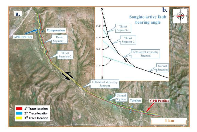
*Figure 12.* La faille active de Songino, a) la ligne rouge indique la première trace de la faille, la ligne bleu est la 2nde trace et la ligne jaune la 3eme trace après le 2eme événement. b) *Quatre différents directions de la trace de la faille avec les angles correspondants.*
