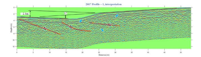
**Figure 11.** Le résultat de l'image GPR du profile P1 de la zone 3D6 (acquis en 2017, voir aussi Figure 10) obtenu avec l'antenne de 250 MHz (voir la localisation sur la Figure 7). Interprétation de l'image radar du profil P1. L'image radar montre clairement une structure chevauchée (lignes rouges), les flèches noires montrent la direction de la déformation. La hauteur de l'escarpement est, de 2.1 m.
