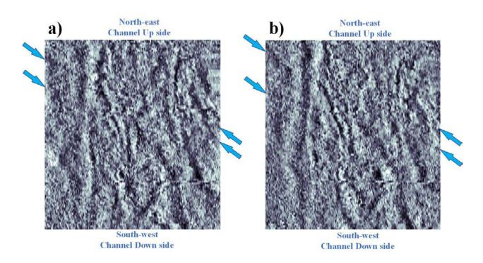
**Figure 6**. Résultat des 'depth slices' du cube de données pseudo-3D C1 (acquis en juin 2010) obtenu avec une antenne blindée de 500 MHz dans le paléo chenal fluvial de la faille active d'Emeelt. a) « Depth slice » à 0,48 m sous la surface du sol, b) « Depth slice » à0,53 m sous la surface du sol, flèches bleues indiquant les traces de faille.
