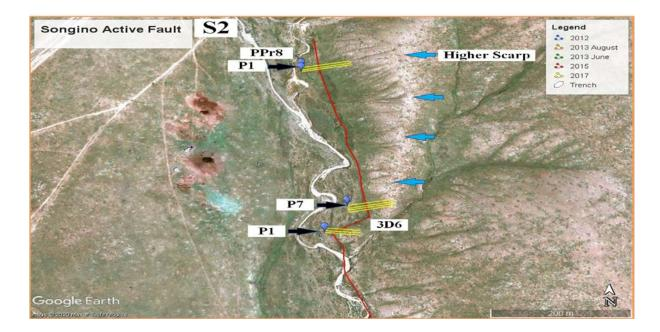
**Figure 10**. Carte de localisation des profils GPR mesurés en aout 2017, la zone d'étude GPR S2 est montrée sur la Figure 7. Les lignes jaune indiquent les profils GPR perpendiculaire à la faille, la ligne rouge est la trace de la faille, les symboles bleus indiquent le début des profils. Les flèches bleues pointent le chevauchement de l'escarpement de la faille.
