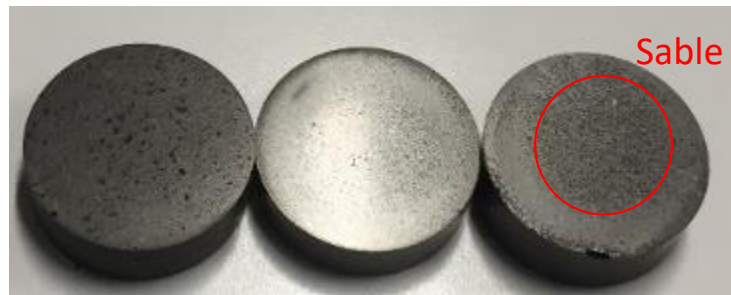
Figure II.5 : Echantillon d'éprouvettes de sables enrobés dans de la résine avec de la poudre de nickel pour une étude au MEB-EDS
