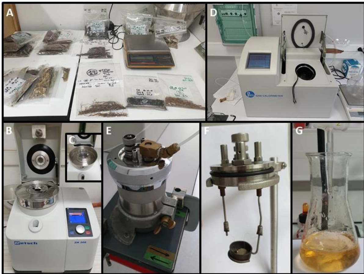
Figure 3-15. A. Pesée des échantillons lyophilisés. B. Broyeur. C. Grille du broyeur. D. Calorimètre. E. Bombe calorimétrique. F. Support à placer dans la bombe calorimétrique, permettant de placer la cupule contenant l'échantillon sous forme de pastille compacte. G. Titrage des acides. Crédit photo : CNRS.
