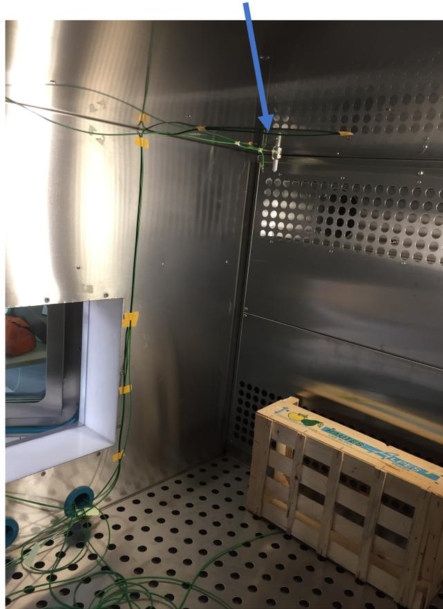
Figure 2.16 Instrument intégré PT-100 à l'intérieure d'une chambre climatique
