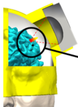
FIGURE 2.6 – Dispositif proposé dans [26], dont l’architecture globale pourrait également être mécaniquement adaptée aux contraintes de l’oBHE avec de l’eau comme milieu de couplage (source : [26]).
