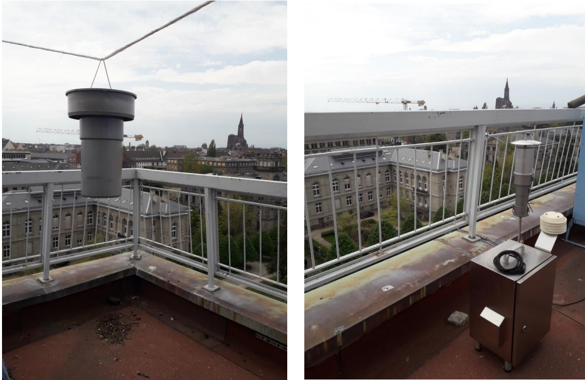
Figure 2.7 : Photo d'échantillonneurs passif (gauche) et photo de l'échantillonneur actif « Sven Leckel » (droite)
