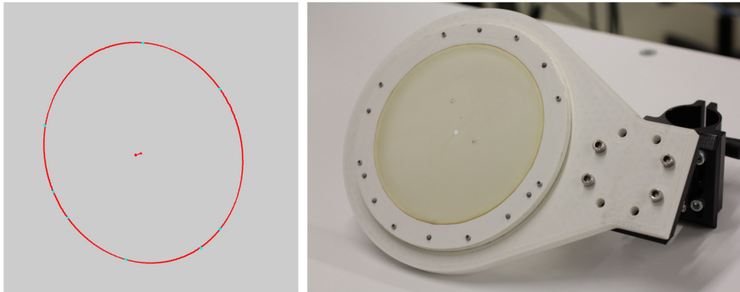
FIGURE 6.9 – Système de tension de peau. À gauche, la régression du cercle formé par les marqueurs points. À droite, une photo de la peau réelle sous tension avec le point d'entrée poinçonné.
