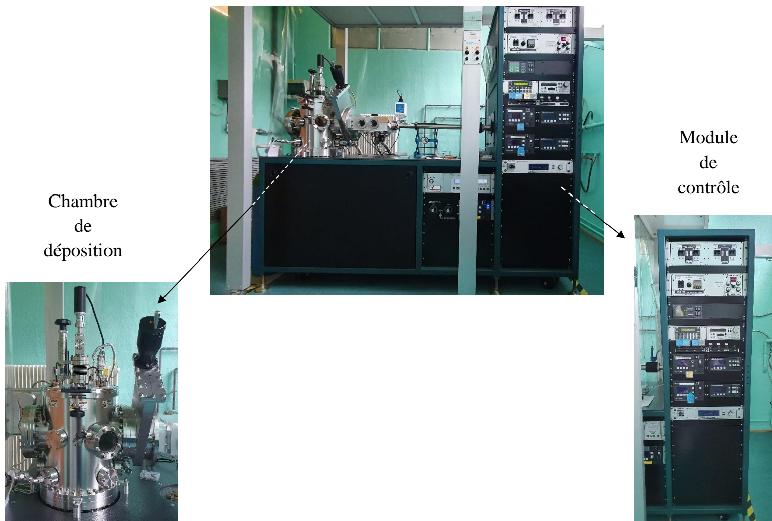
Figure 29 : Photographie du montage de pulvérisation cathodique magnétron réactive du laboratoire ICube.
