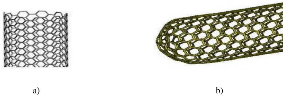
Figure 8 : Types de nanotubes de carbone en fonction du type d'extrémité a) ouvert et b) fermé [97]
