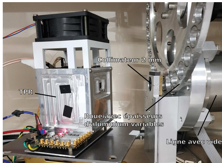
FIGURE 2.5 – Photo d'une expérience avec le TPR à l'accélérateur Cyrécé. Le détecteur est positionné à l'extrémité de la première ligne de faisceau, avec la roue et un collimateur de 2 mm.
