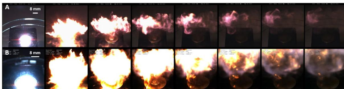
**Figure 9** : Images de combustion par allumage optique des mélanges énergétiques (A) Al/SnO<sub>2</sub> SA et (B) Al/SnO<sub>2</sub> AA. L'intervalle de temps entre chaque image est de 0,5 ms.
