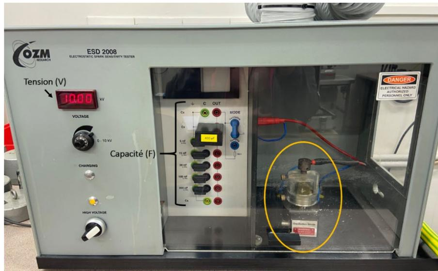
*Figure 6 : Appareil d'OZM Research pour la détermination du seuil à la décharge électrostatique. La partie entourée en jaune correspond au dispositif où se situe la matière énergétique.*
