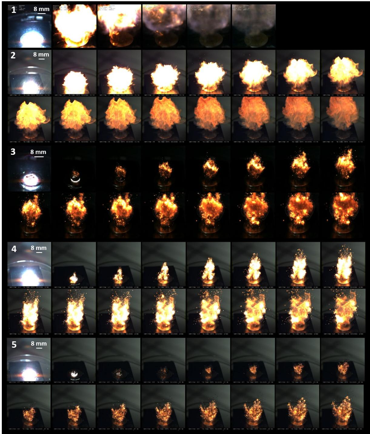
**Figure 24** : Images de combustion, par allumage optique, des mélanges énergétiques ( $t = 1$  h) : (1) Al/SnO<sub>2</sub>, (2) Al/SnO<sub>2</sub>-PPy-d (PPy = 1,7 %), (3) Al/SnO<sub>2</sub>-PPy-c (PPy = 4,2 %), (4) Al/SnO<sub>2</sub>-PPy-b (PPy = 5,5 %) et (5) Al/SnO<sub>2</sub>-PPy-a (PPy = 8,9 %). L'intervalle de temps entre chaque image est de 1 ms.
