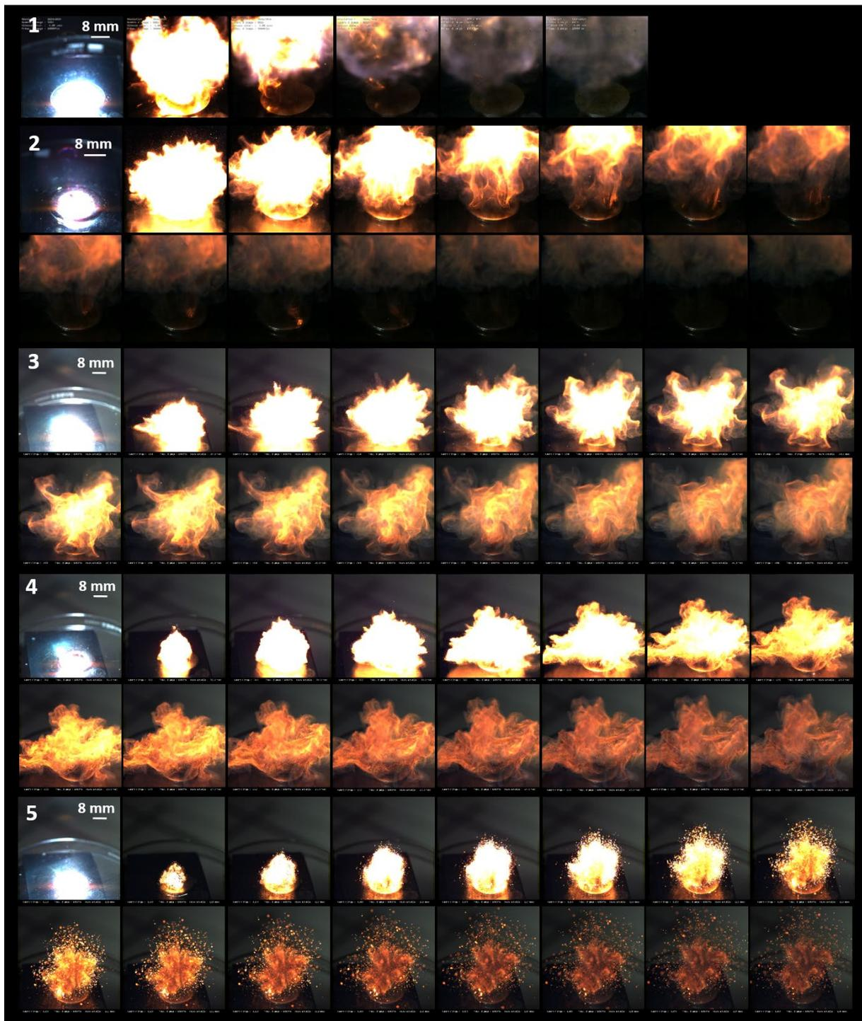
**Figure 25** : Images de combustion, par allumage optique, des mélanges énergétiques ( $t = 24$  h) : (1)  $\text{Al}/\text{SnO}_2$ , (2)  $\text{Al}/\text{SnO}_2\text{-PPy-}\delta$  ( $\text{PPy} = 1,1\%$ ), (3)  $\text{Al}/\text{SnO}_2\text{-PPy-}\gamma$  ( $\text{PPy} = 3,4\%$ ), (4)  $\text{Al}/\text{SnO}_2\text{-PPy-}\beta$  ( $\text{PPy} = 5,6\%$ ) et (5)  $\text{Al}/\text{SnO}_2\text{-PPy-}\alpha$  ( $\text{PPy} = 9,6\%$ ). L'intervalle de temps entre chaque image est de 1 ms.
