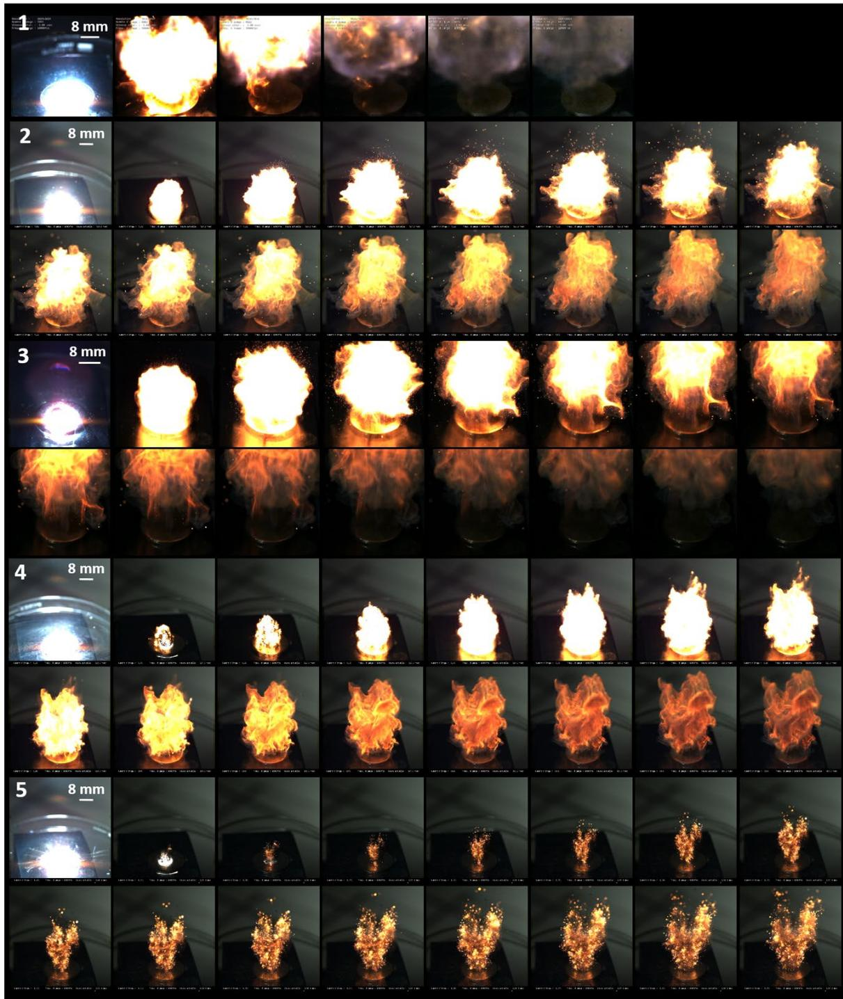
**Figure 23** : Images de combustion, par allumage optique, des mélanges énergétiques ( $t = 0$  h) : (1) Al/SnO<sub>2</sub>, (2) Al/SnO<sub>2</sub>-PPy-D (PPy = 1,5 %), (3) Al/SnO<sub>2</sub>-PPy-C (PPy = 2,8 %), (4) Al/SnO<sub>2</sub>-PPy-B (PPy = 4,7 %) et (5) Al/SnO<sub>2</sub>-PPy-A (PPy = 8,4 %). L'intervalle de temps entre chaque image est de 1 ms.
