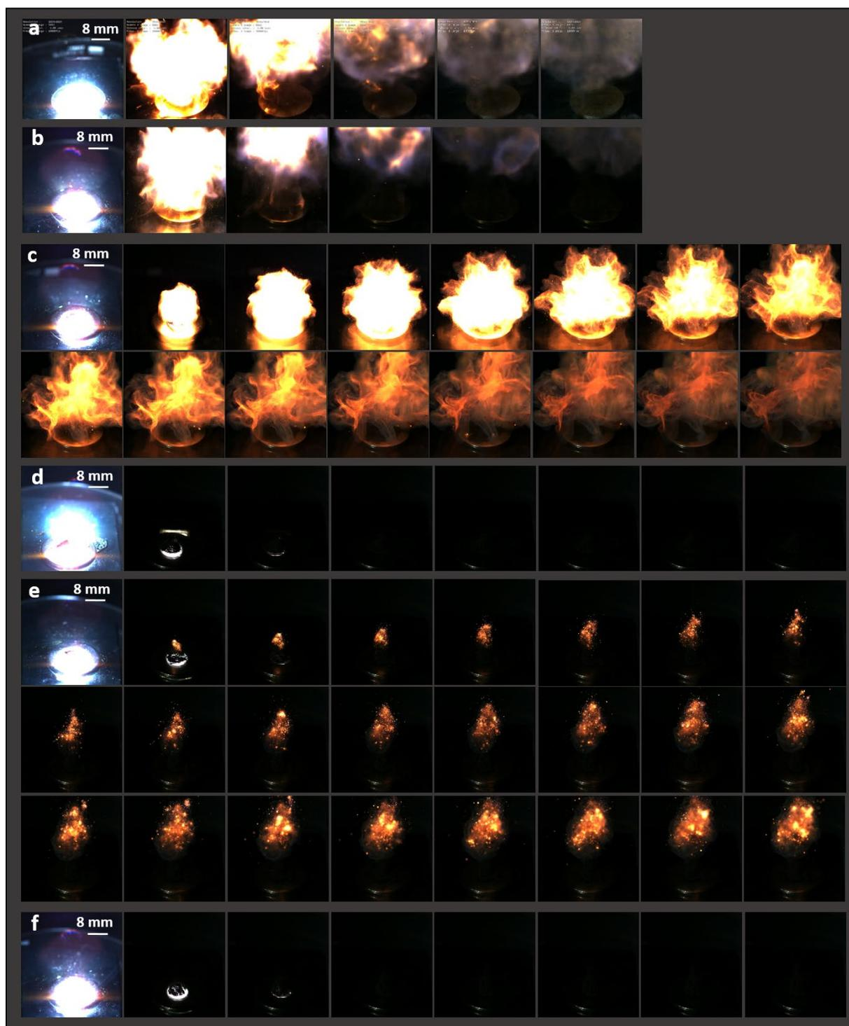
**Figure 31** : Images de combustion par allumage optique des mélanges énergétiques par la synthèse one pot : (a) Al/SnO<sub>2</sub>, (b) Al-SnO<sub>2</sub>-PPy<sub>1,2</sub>, (c) Al-SnO<sub>2</sub>-PPy<sub>2,3</sub>, (d) Al-SnO<sub>2</sub>-PPy<sub>3,2</sub>, (e) Al-SnO<sub>2</sub>-PPy<sub>5,7</sub> et (f) Al-SnO<sub>2</sub>-PPy<sub>8,0</sub>. L'intervalle de temps entre chaque image est de 1 ms.
