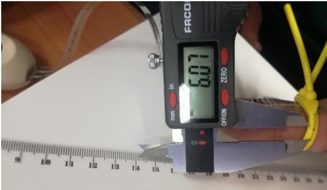
Figure 94, Mesure de distance entre deux marques après un serrage à 200 mmHg
