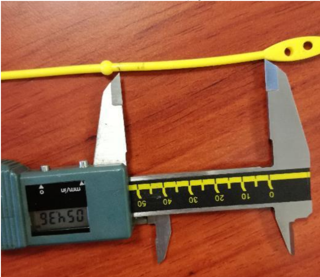
Figure 66, Mesure des éprouvettes dans un garrot avec un pieds à coulisse
