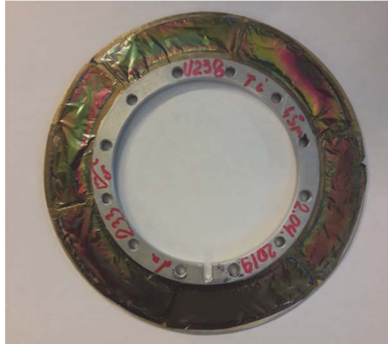
FIGURE 3.7 – Cible d' ^{238}\text{U} déposée sur son support de titane montée sur le cadre rotatif. ^{238}\text{U} target deposited on the titanium backing, on the rotating wheel.
