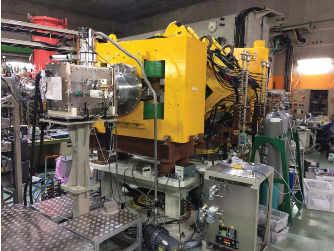
FIGURE 2.18 – Photo du du séparateur GARIS II et de son plan focal. On y retrouve la chambre de détection et une partie de la chaîne d’acquisition sur la gauche. Photo prise par B. Gall.
