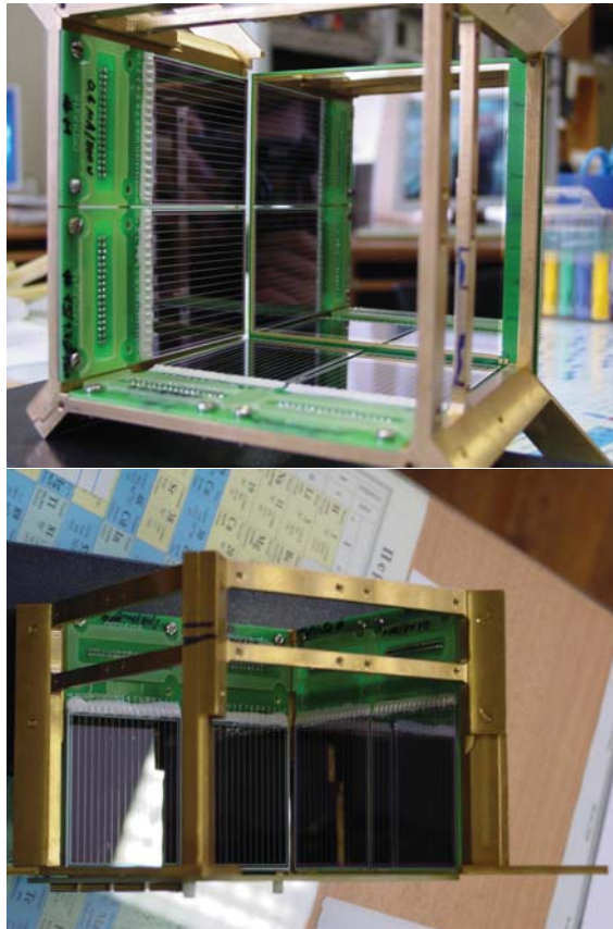
FIGURE 2.10 – (gauche) Vue de face du DSSD d'implantation entouré de 4 des 8 siliciums formant le tunnel. (droite) Vue de côté des détecteurs tunnels. Photos prises par O. Dorvaux.
