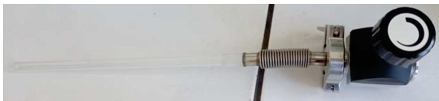
Figure 6 Système utilisé pour effectuer la réaction topotactique sous vide
