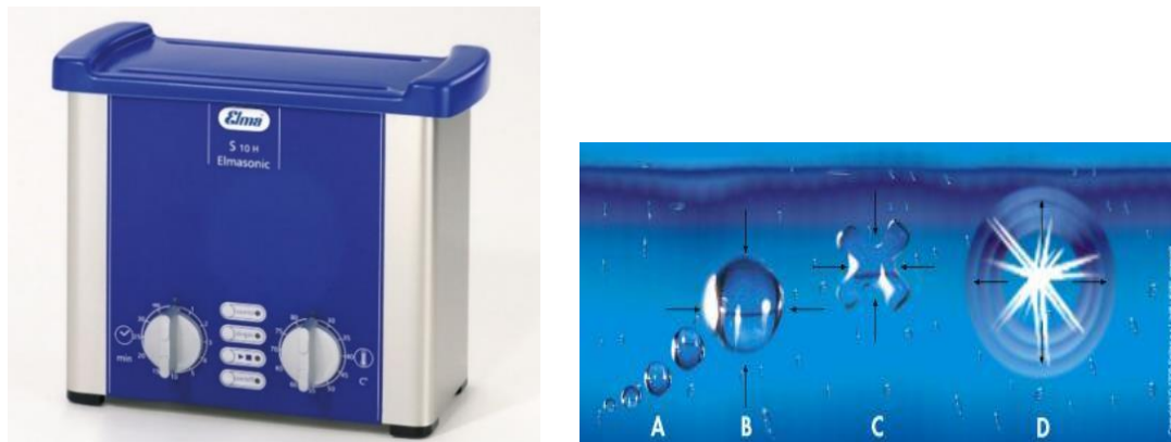
Figure 2.2 : (gauche) photographie du bain à ultrasons (Elma S10H). (droite) La formation de cavités (A et B) et le phénomène d'implosion (C et D), http://www.soltec.it .
