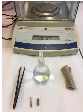
Figure 80 : Pycnomètre 50 ml utilisé pour les mesures de masse volumique
