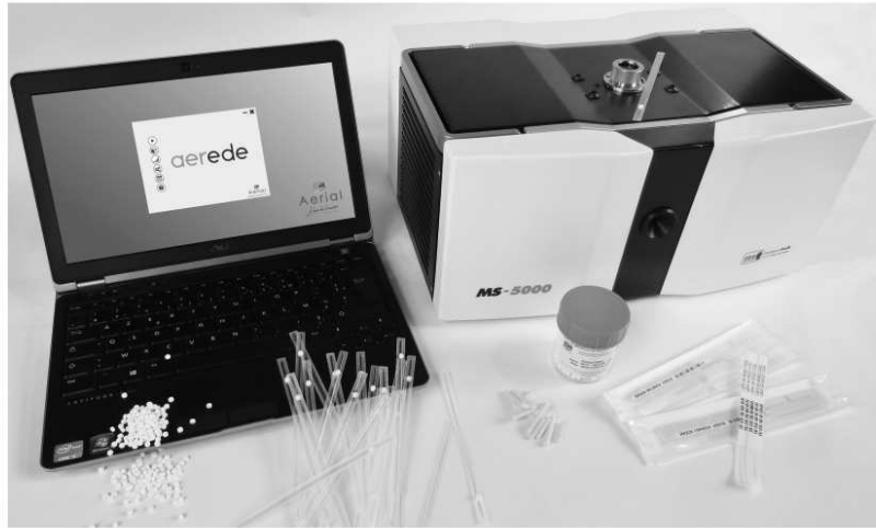
FIGURE 2 – Le logiciel Aer'EDE219 développé et commercialisé par Aerial et le spectromètre MS5000 EPR (Electron Paramagnetic Resonance) [14] utilisés pour la lecture des dosimètres d'alanine [13].
