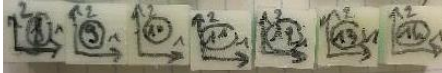
Figure IV-A-3-3 : Echantillons typiques produits pour les essais de caractérisation de l'ABS imprimé 3D
