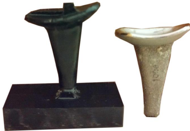
Figure IV-C-3-5: Tentative d'usinage d'un implant radial de prothèse de poignet (ReMotion)
