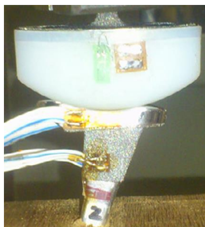
Figure I-D-3-3 : Instrumentation d'une prothèse de poignet par jauge de déformation et réseau à fibre de Bragg (Gislason et al., 2016)
