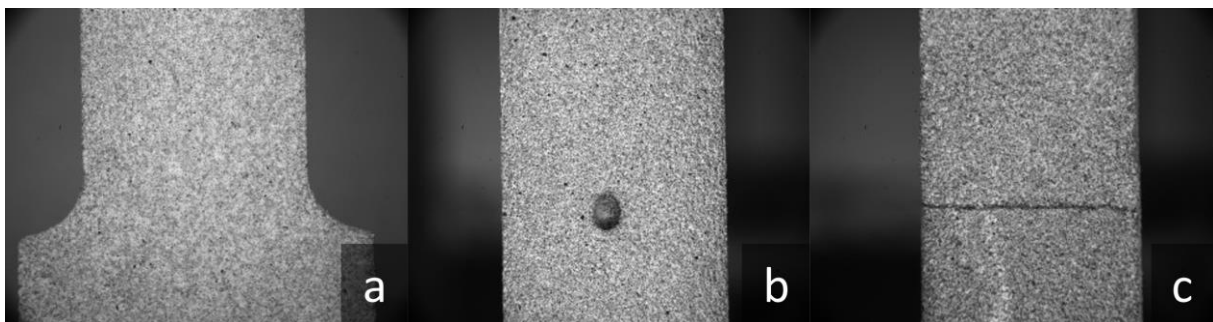
Figure III-C-3-1 : Images acquises avec la caméra Basler pour la corrélation d'images. (a). Éprouvette pleine ; (b). Éprouvette percée ; (c). Éprouvette enfouie avec plans à 45°
