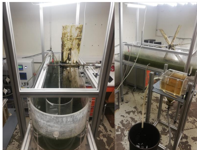
Figure 48. Photo du chenal à haut rendement algal avec le décanteur
