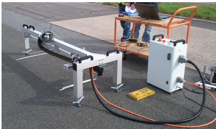
Figure IV-1: Système de mesure de texture 3D (Cesbron and Klein, 2016).
