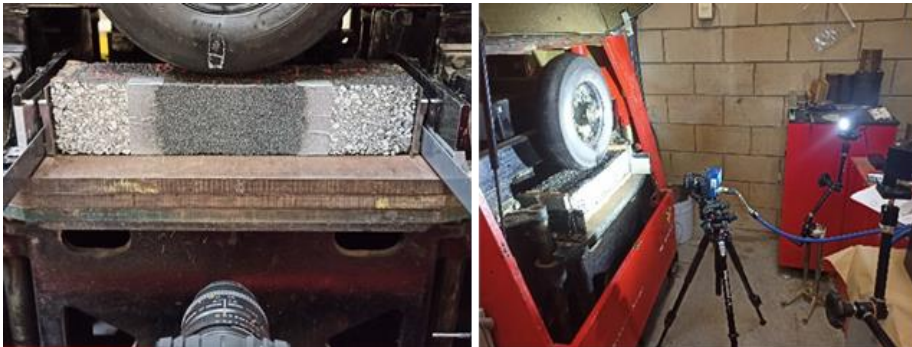
Figure V-4: Dispositif des instruments de mesure pour l'expérience (WTT, UGE).
