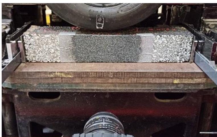
Figure V-1: Disposition des instruments de mesure pour l'expérience (WTT, UGE)
