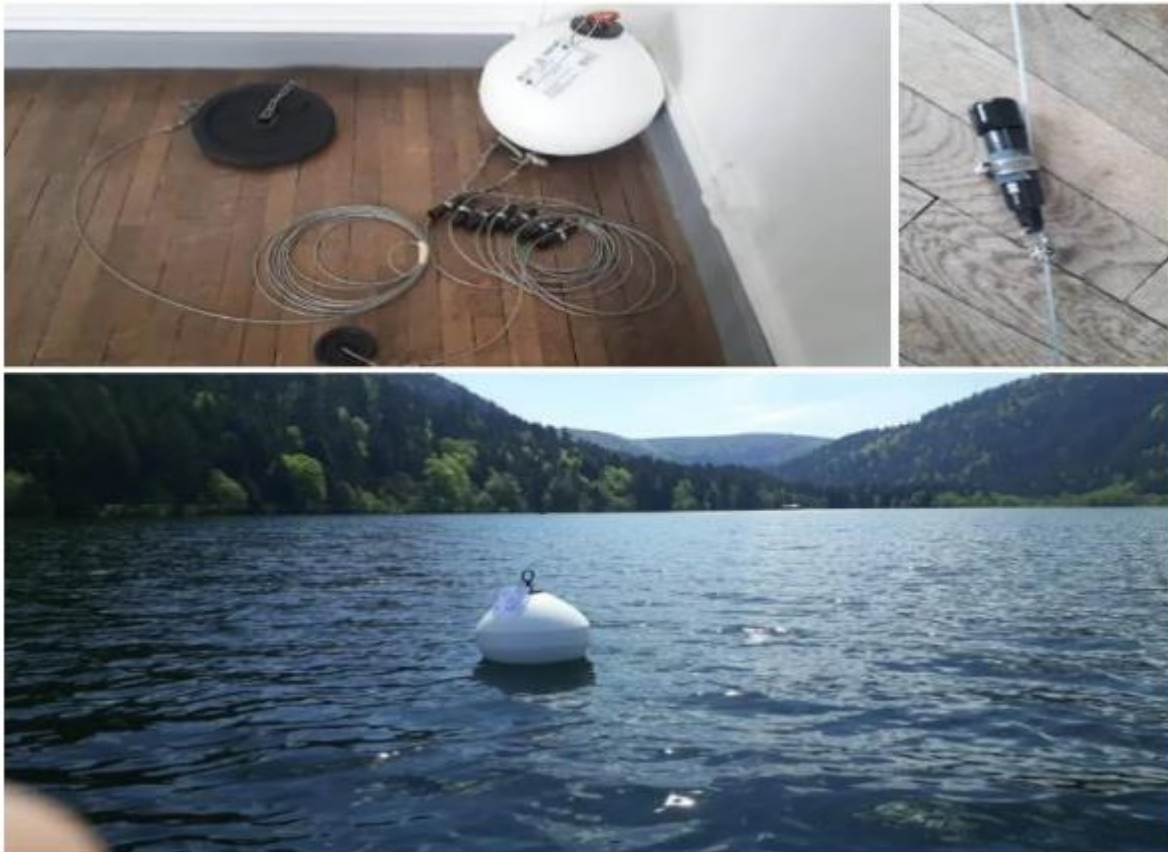
Figure 21. Buoy in Gérardmer Lake is used to measure the temperature at various levels of the lake (Suivi Climatique National & Fonctionnement Des Lacs: Une Bouée Installée Sur Le Lac de Gérardmer - Gerardmer Info, n.d.).
