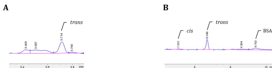
Figure 52. Profils HPLC selon la méthode (A) 7min ou (B) 20min du **LIT-01-277** à 50  $\mu$ M dans un tampon HEPES/BSA(1%) après élimination de la BSA
