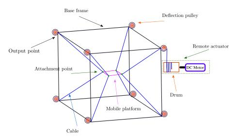
Figure 1: Structure d'un robot parallèle à à 8 câbles et 6 degrés de liberté.
