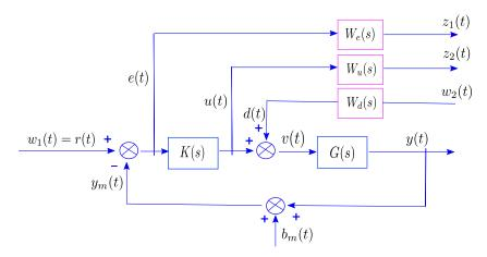
Figure 6: Le schéma de synthèse à quatre blocs.
