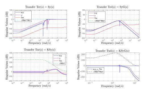
Figure 7: Réponse fréquentielle de la boucle fermée avec les gabarits fréquentiels (pointillé) avec schéma de synthèse  $\mathcal{H}_{\infty}$  à quatre blocs.
