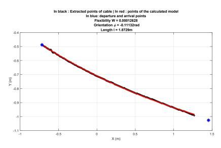
Figure 5: La reconstruction du câble à partir de la vidéo
