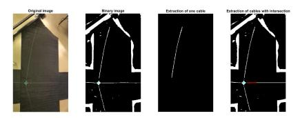
Figure 4: Extraction de câble à partir d'un flux vidéo (a. image originale b. image binaire c. extraction d'un câble d. extraction des câbles avec intersection).
