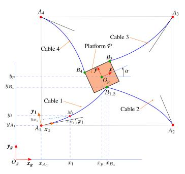
Figure 2: Représentation d'un robot parallèle plan à 4 câbles flexibles.
