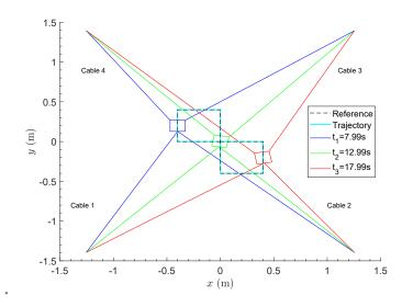
Figure 8: Trajectoires de la plate-forme et des câbles dans le plan x - y avec le correcteur  $\mathcal{H}_{\infty}$ .
