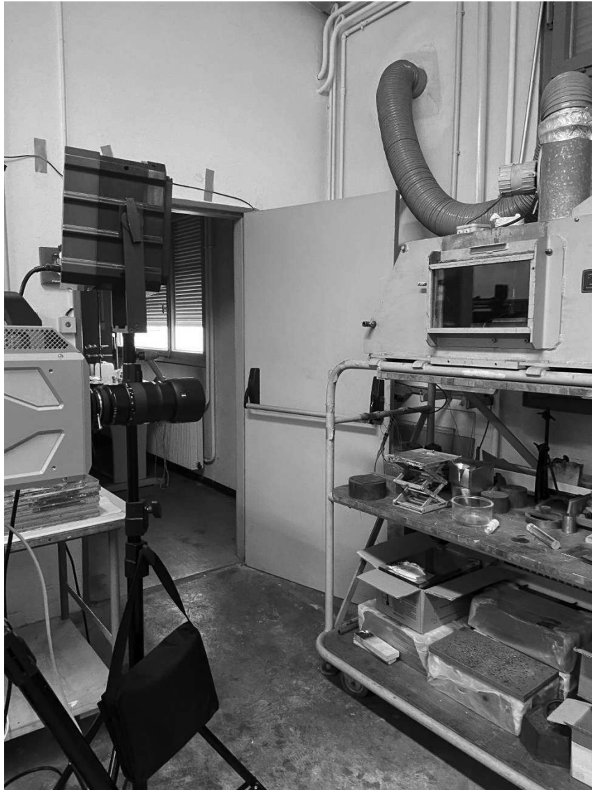
Figure 11 : Photo du dispositif caméra rapide (à gauche) et du caisson de détonation (à droite)
