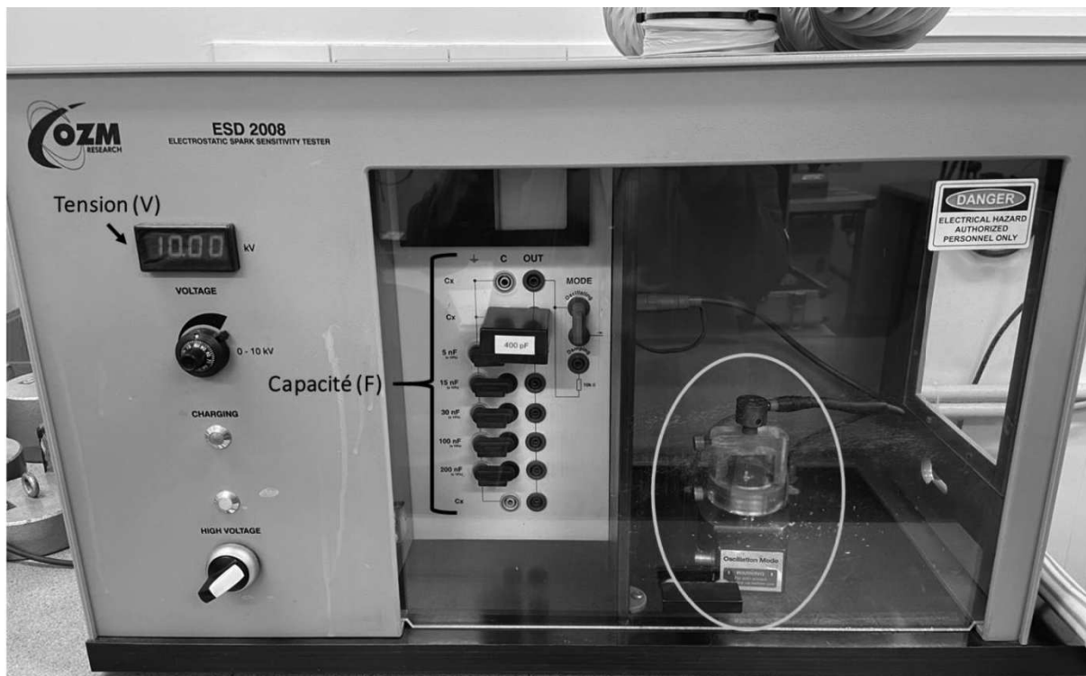
Figure 10 : Appareil ESD 2008A du fournisseur OZM research
