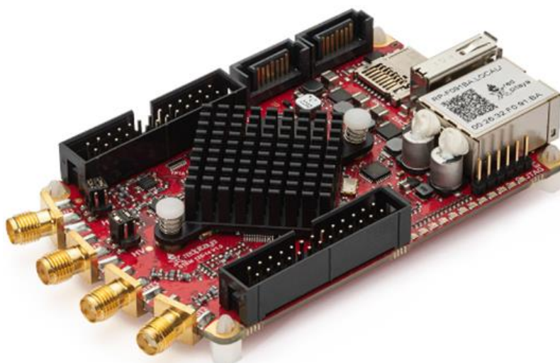
Figure 14 : Carte radio logicielle Red Pitaya STEMLab 125-14.
