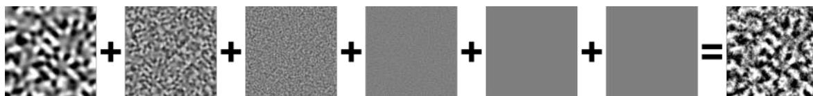
**FIGURE 2.30** – Le bruit fractal (à droite) est composé d'une somme de réalisations d'un même bruit à des fréquences croissantes et des amplitudes décroissantes.
