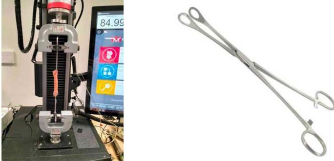
Figure 67 : Segment de nerf sciatique positionné dans l'appareil de mesure (image de gauche) et arrimé par deux pinces Foerster (image de droite)
