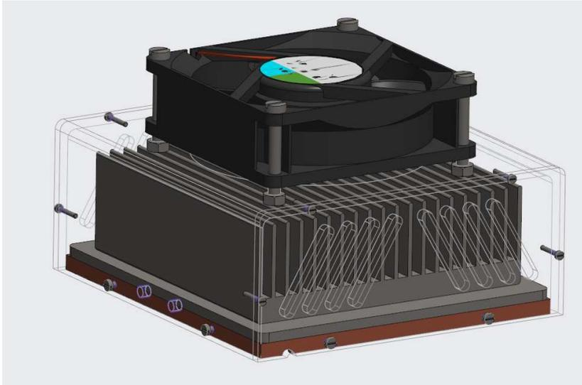
Figure 139: CAO de l'échangeur final. Seule Une des moitiés de l'échangeur est représenté. Il est agencé de bas en haut par le cuivre (en marron), le radiateur (en gris) et le ventilateur (en noir). Le bâti permettant de maintenir l'ensemble et de réaliser la pince est en transparence
