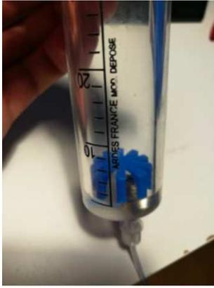
Figure 40 : utilisation d'une grille pour maintenir le tissu adipeux dans la seringue et éviter l'obturation de l'orifice de sortie
