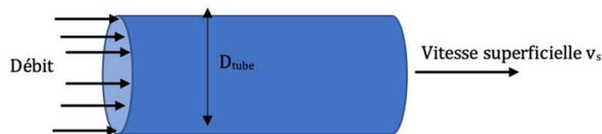
Figure 64 : Schéma de l'écoulement d'un fluide à travers un tuyau
