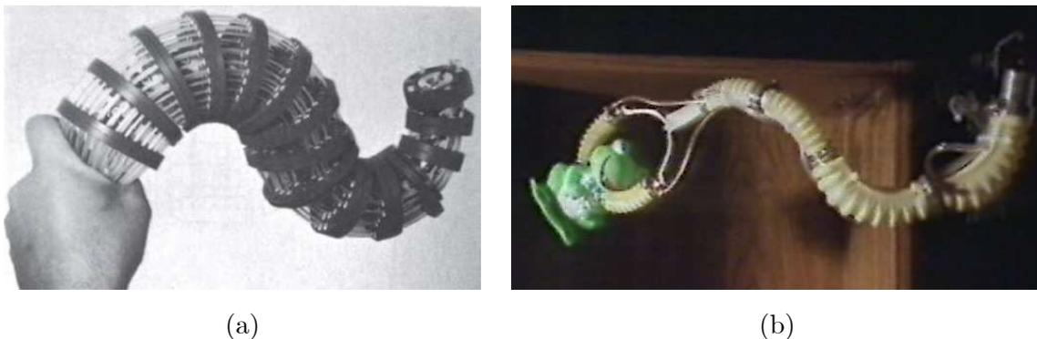
FIGURE 1.5 – Photographies du robot hyper-redondant Tensor Arm développé en 1967 par Victor Anderson et Ronald Horn (a) et du robot doté d'un actionnement fluïdique développé par James Wilson en 1985 (b). Adapté de [[Open Continuum Robotics, 2022b](#)] et [[Open Continuum Robotics, 2022a](#)].
