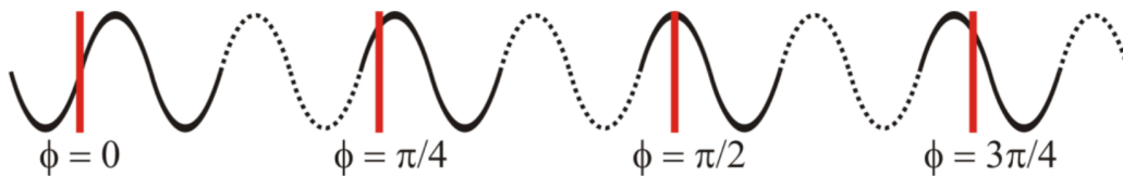
FIGURE 5.4 – Schéma illustrant le concept d'éclairage stroboscopique. Des impulsions d'illumination très courtes sont verrouillées en phase et parcourent la période de vibration de manière progressive [16].
