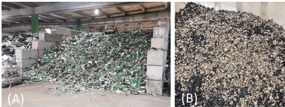
Figure I.12 : Prétraitement des déchets d'équipements électriques et électroniques, WEEECycling, 2023. (A) Zone de stockage des cartes électroniques après démantèlement. (B) Limaille grossière obtenue à la fin des étapes de prétraitement.
