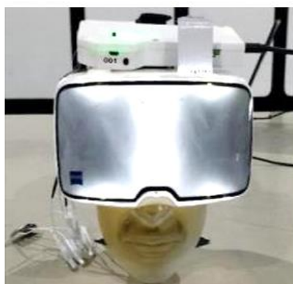
Figure 41. Photographie de la stimulation flash du Retinaute® (Version 1.0). Les stimulations flashs pour les examens fERG et fEEG sont générées par le biais de modules LED lumineux directement intégrés au dispositif et situés sur le pourtour des yeux du participant. L'expérimentateur décide quand démarre l'examen fERG ou fEEG grâce au logiciel présent sur l'ordinateur de l'étude qui communique avec le Retinaute® via une communication Bluetooth.
