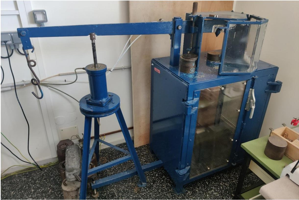
Figure 15: Presse hydraulique utilisée pour la compression dans les tubes
