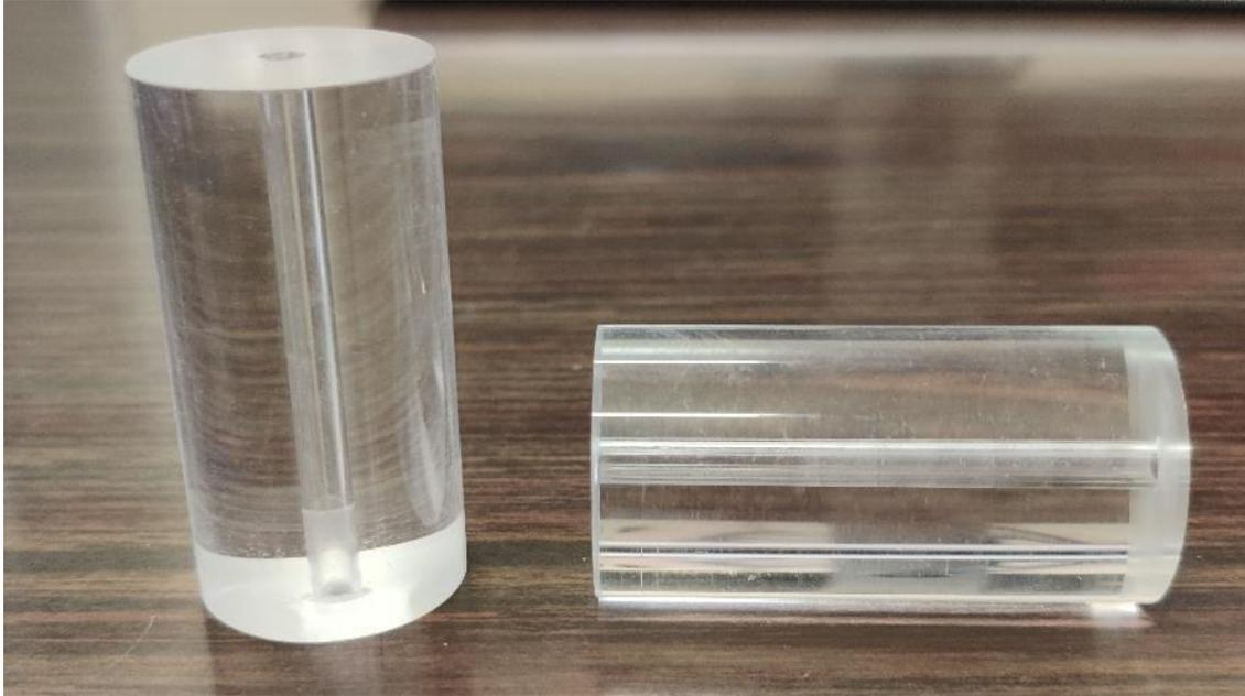
Figure 14: Tubes en PMMA utilisés lors des tests de détonation
