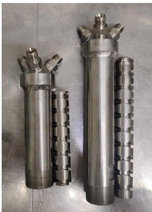
Figure 14 : Dispositif permettant le mélange des liquides en amont de la buse du réacteur SFE
